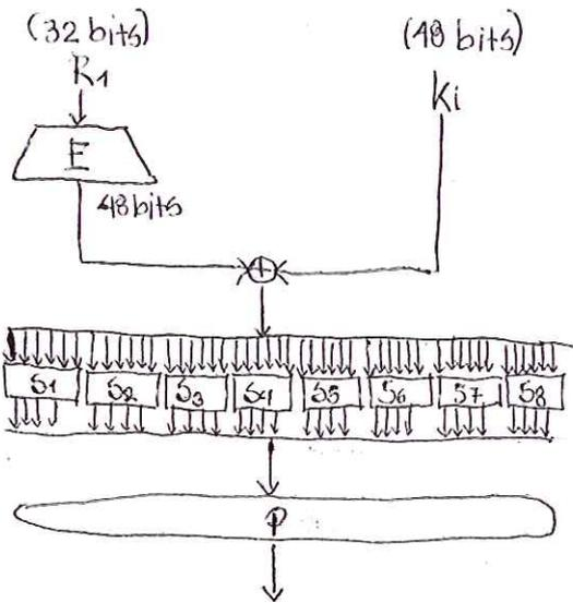
La fonction  $F$  est basée sur les principes de Shannon (substitution-permutation)
