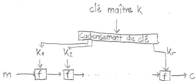
Utiliser un algorithme de cadencement des clés afin d'éteindre la clé maître à une séquence de  $r$  sous-clés.
